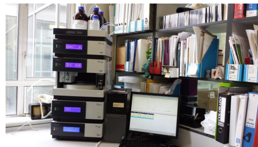
Équipement destiné aux techniques de chromatographie liquide haute performance (HPLC) à l'École d'hygiène et de médecine tropicale de Londres
